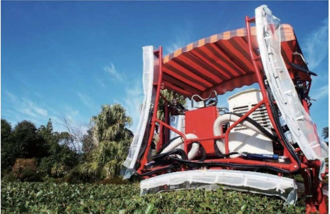
鹿児島県農業開発総合センター茶業部と松元機工株式会社は、病虫害の発生状況等によっては従来の農薬散布量（200L/10a）を約15%～65%削減して、これまでと同等の病虫害防除効果を発揮する農薬散布機4機種を開発しました。
