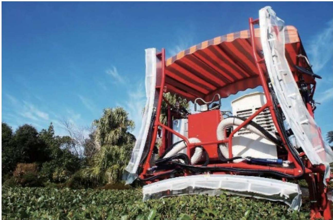
鹿児島県農業開発総合センター茶業部と松元機工株式会社は、病害虫の発生状況等によっては従来の農薬散布量(200L/10a)を約15%～65%削減して、これまでと同等の病害虫防除効果を発揮する農薬散布機4機種を開発しました。
