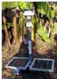
(18)固定カメラ + ソーラパネル
